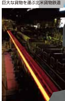
レールは鉄に圧力をかけて伸ばしてつくる
